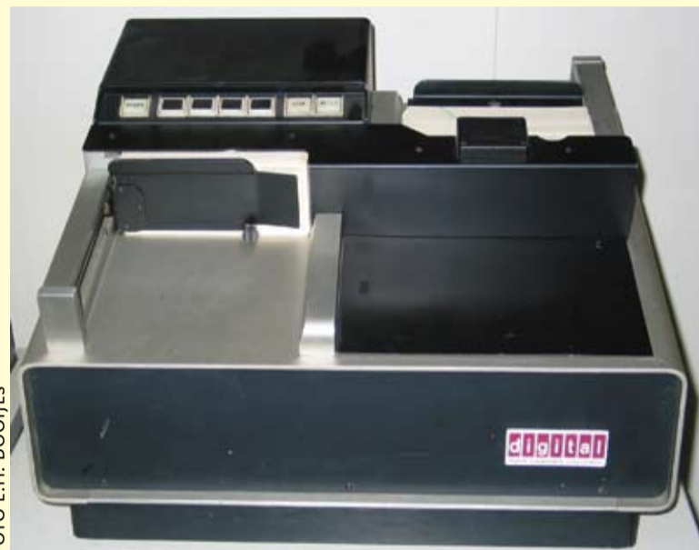
De Ducumation M300 (ca 1975) leest, aangesloten aan een Digital PDP11 minicomputer, 300 pons- of schrapkaarten per minuut.
